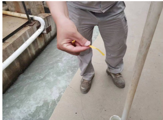
4. 中和事故池，检测小组检测 pH 值
