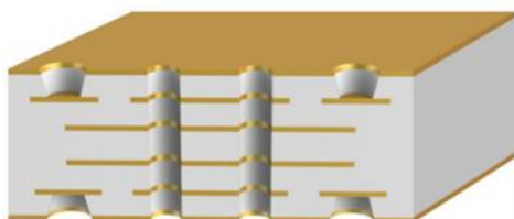
化学沉铜前 (孔壁绝缘基材无铜覆盖)
