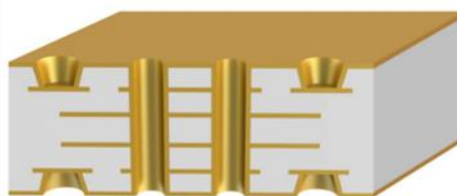
化学沉铜后 (孔壁绝缘基材覆盖铜)
