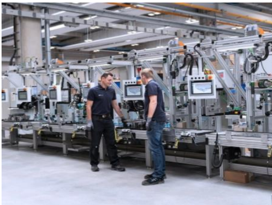
图：800V 变压测试系统
