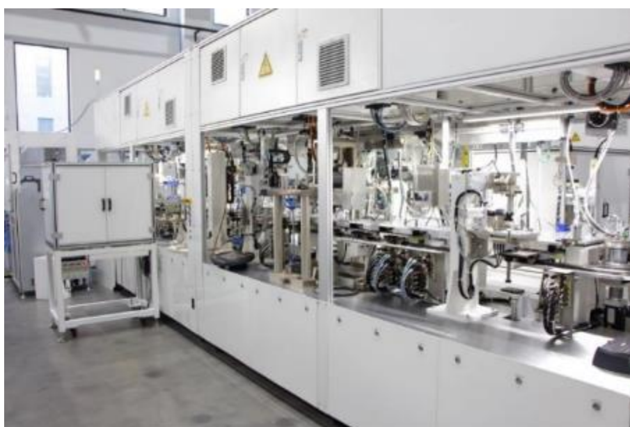
图:线控制动智能刹车系统应用磁悬浮传输系统
