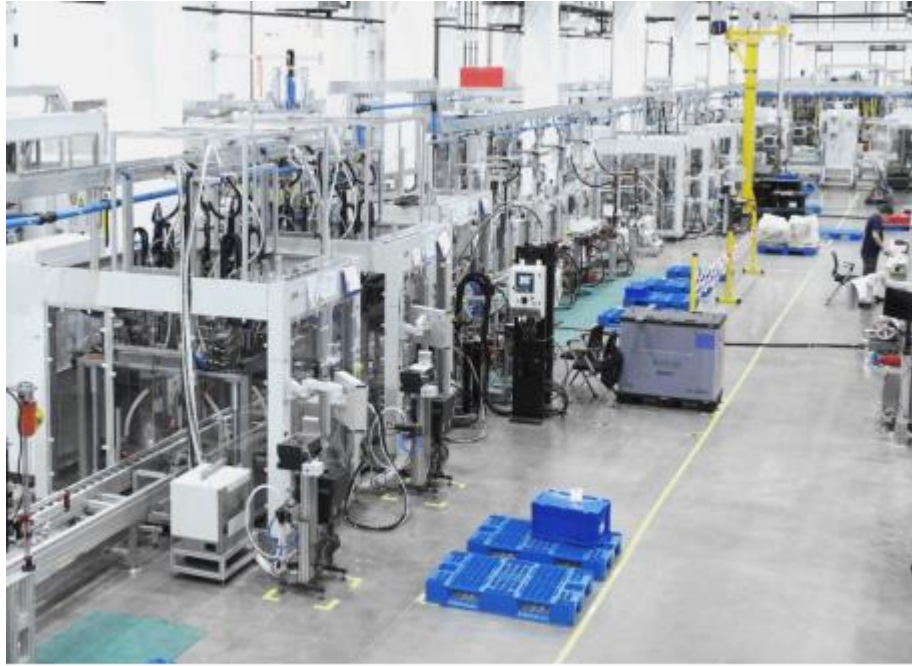
图：三合一电驱的装配和测试系统
