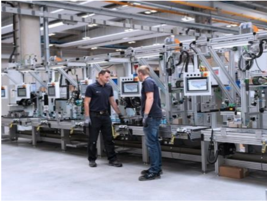
图：800V 变压测试系统
