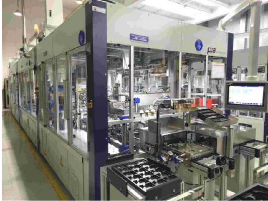
图：4D 毫米波雷达的装配与检测线
