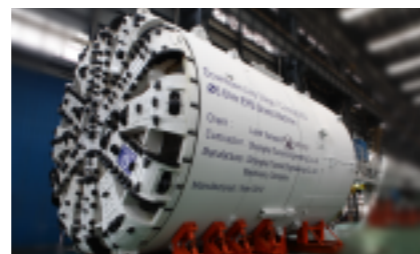
隧道股份研发制造新加坡“南洋号”盾构
