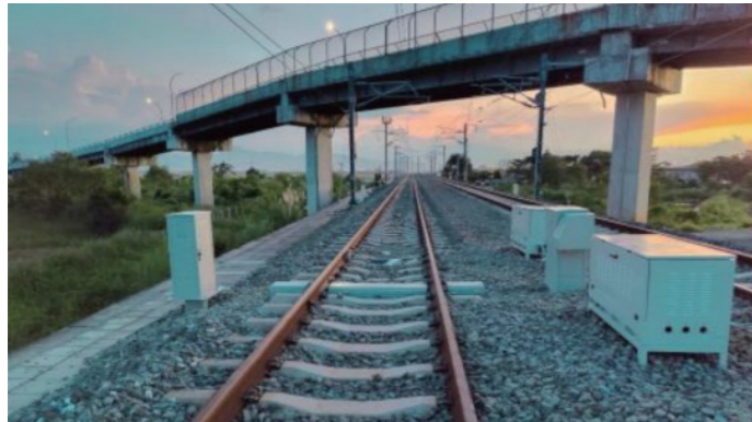
▲应用于雅万高铁的动车组运行故障图像检测系统轨边设备
