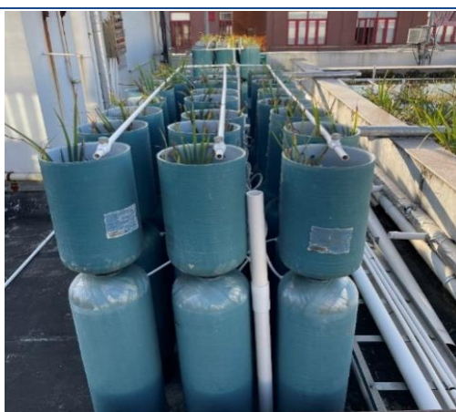
图：公司将废弃复合材料压力容器裁制成盆栽容器
