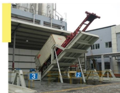
集装箱卸料实景图
