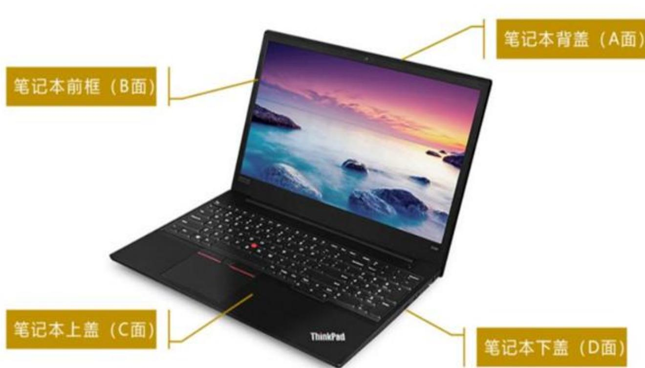
公司生产的笔记本电脑结构件模组产品按材质分为塑胶结构件和金属结构件。塑胶结构件是起结构支撑固定等作用的塑胶部件，是最典型的笔记本电脑结构件产品，主要包括背盖、前框、上盖、下盖等四大件。金属结构件是外观主体件和起结构支撑固定等作用的金属部件，主要包括背盖、上盖、下盖等三大件。
