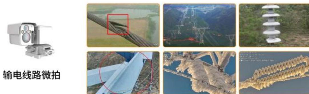
公司输电线路智能微拍具备多摄像头监控、夜视全彩、低功耗、边缘计算等特点，可对输电线路导线、绝缘子及金属异常以及塔杆周边环境、通道环境、山火情况进行全天候低功耗监测，保障输电线路的运行安全。
