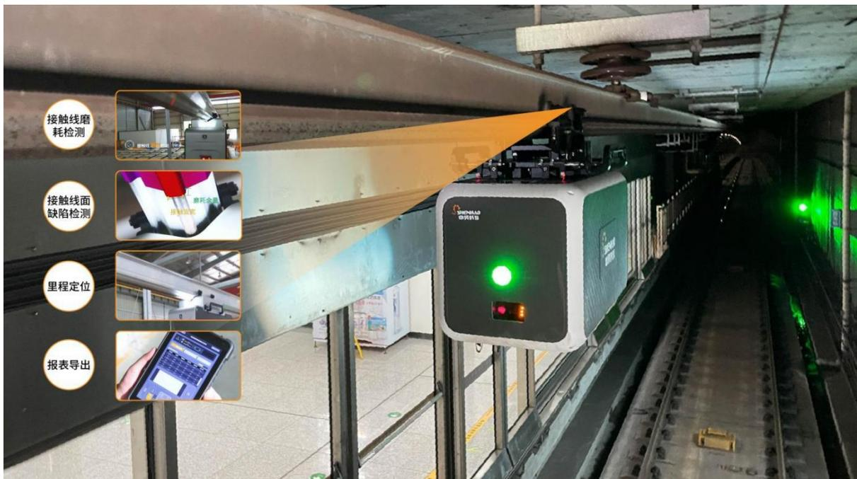
公司刚性接触网巡检机器人运行在刚性接触网汇流排上，能够对刚性接触网接触面宽、磨耗余量、偏磨角度进行高精度测量，对接触线表面拉丝等表面伤损缺陷进行识别定位。
