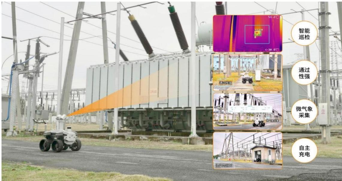
公司自主研发的室外轮式巡检机器人融合自主导航定位、非接触检测、多传感器、后台大数据分析等技术，可实现站内不同高度和位置的表计读数、开关位置识别、红外精准测温、声音、气体以及对站内工况环境的异常和安全性进行智能评估并主动预警。该产品已在电网变电站、发电厂升压站、铁路牵引变、换流站、高能耗行业电力场站应用。
