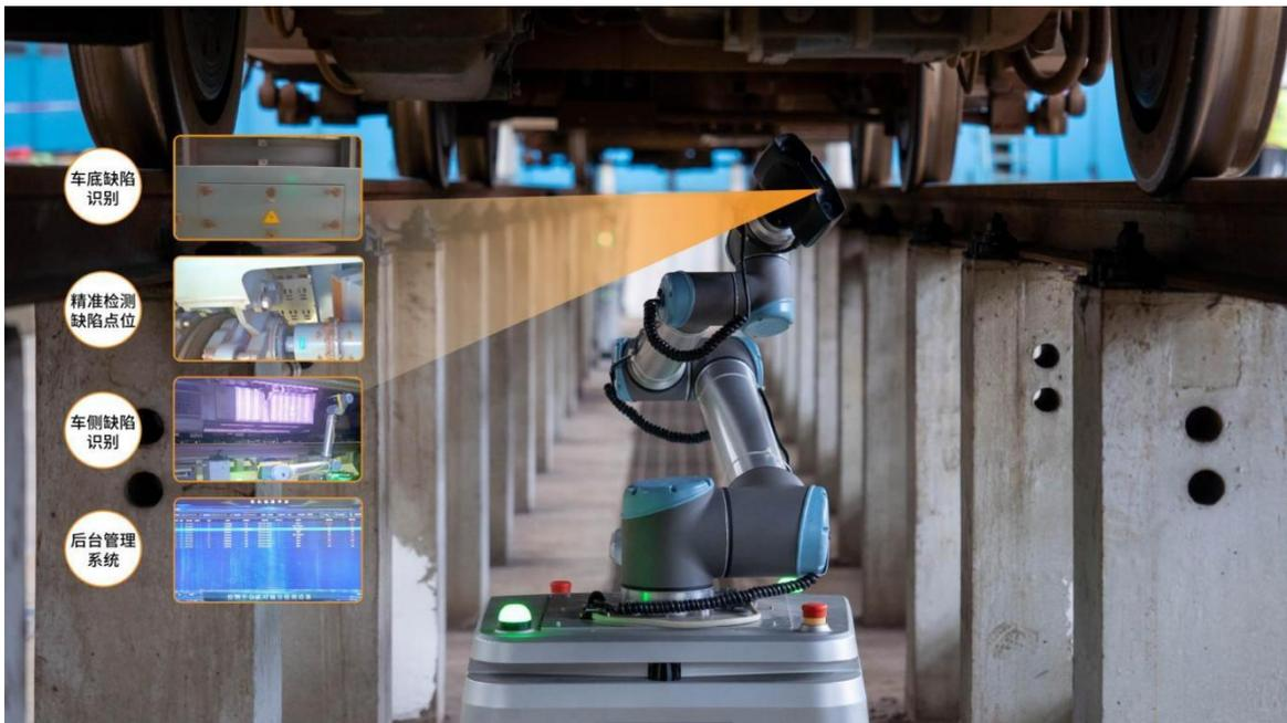
公司列车车底检测机器人采用轮式运动平台组合机械臂、视觉系统的方式运行于列车检修地沟中对列车车底螺栓、管线、排风口、油位阀门以及车侧转向架、车辆车轮、车侧表面缺陷等进行检测，协助、代替人工完成列车车底、车侧外观的检测任务，降低工作强度，提升检修质量，发现列车运行的安全隐患。
