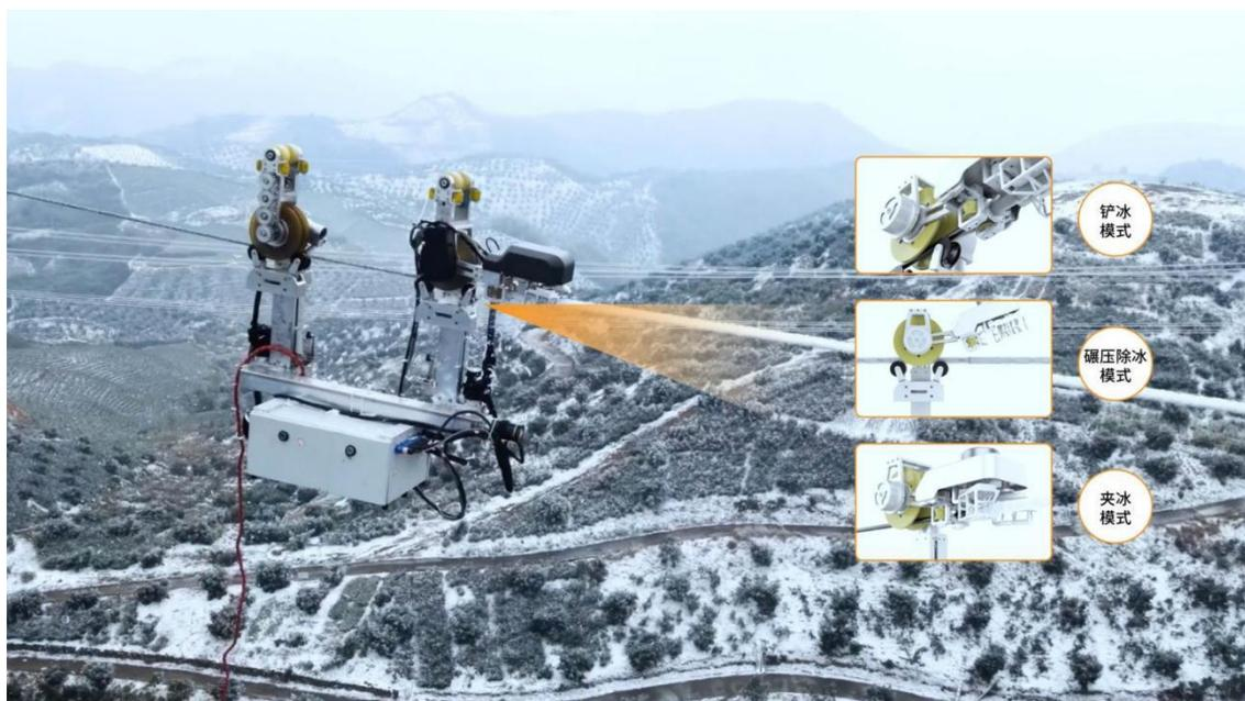
公司输电线路机器人具备对输电线路杆塔、绝缘子、金具、导线等目标的巡检功能，也可搭载除冰作业模块、涂覆作业模块、散股修复模块以分别实现地线覆冰清除和线路绝缘涂层、防覆冰涂层涂覆、线路散股修复的功能。
