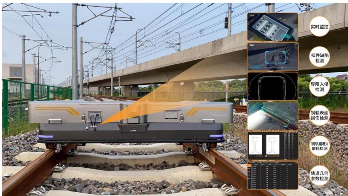
公司轨交线路巡检机器人采用钢轨轮式自行走运动平台组合各类高精尖检测系统，能够对轨道扣
