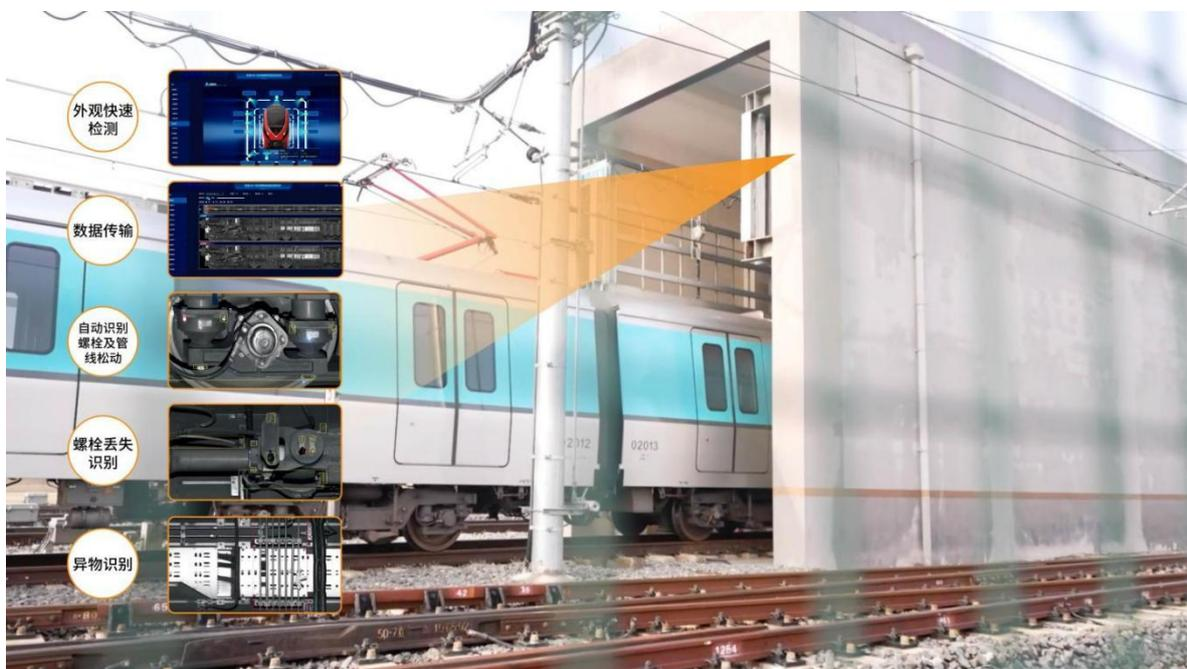
车辆 360° 动态图像智能检测系统利用数字图像处理技术与自动控制技术相结合，利用轨边三维图像检测装置采集运行车辆车顶、走行部、制动部件、底架悬吊件、钩缓连接等可视部位高清图像，识别车辆走行部、底部、侧部、顶部等关键部件状态。
