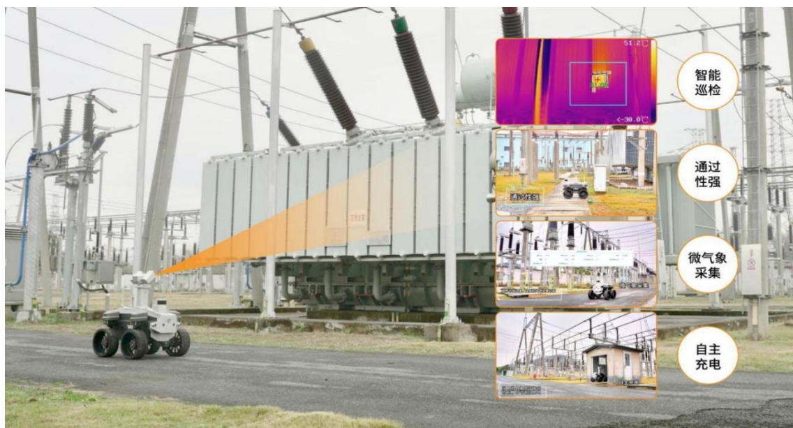
公司自主研发的室外轮式巡检机器人融合自主导航定位、非接触检测、多传感器、后台大数据分
