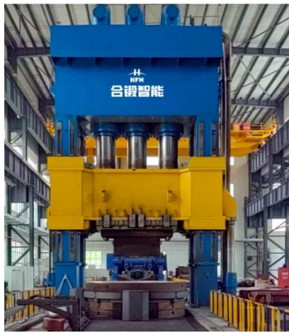
快速锻造液压机生产线
