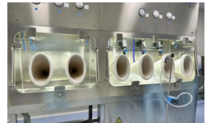
高活性药物粉尘管控密闭设施
