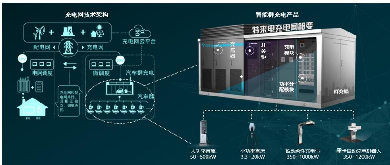
新能源微电网系统产品主要包括新能源微电网箱变、新能源光储充一体化车棚、梯次储能系统等，采用模块化设计和标准化接口，能够通过公司自主研发的微网控制器高效聚合电动汽车充放电、分布式光伏发电、常规储能和梯次电池储能等资源，实现能源监控、经济优化、调度响应等多种功能。
