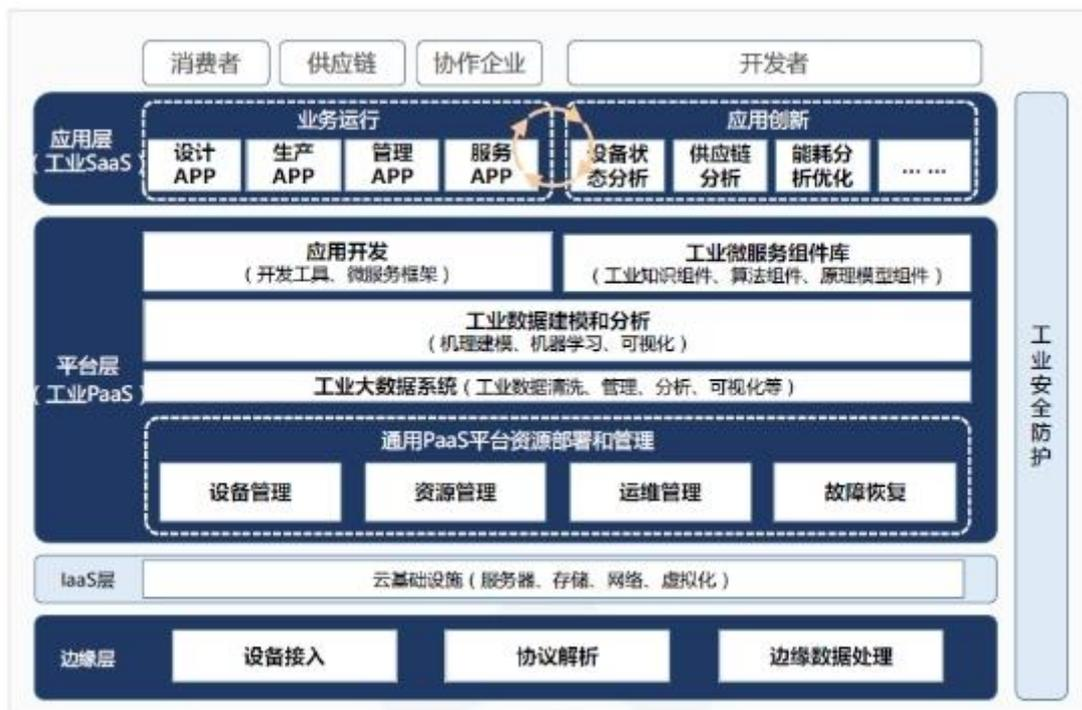
从图中可见，整个工业互联网平台呈现出清晰的层级架构，涵盖边缘层、IaaS层、平台层（也叫工业PaaS层）、应用层（也叫工业SaaS层）以及贯穿上述各层级的安全防护。其中，边缘层、平台层、应用层是工业互联网平台的三大核心层级。公司业务领域也主要覆盖这三大核心层级：
