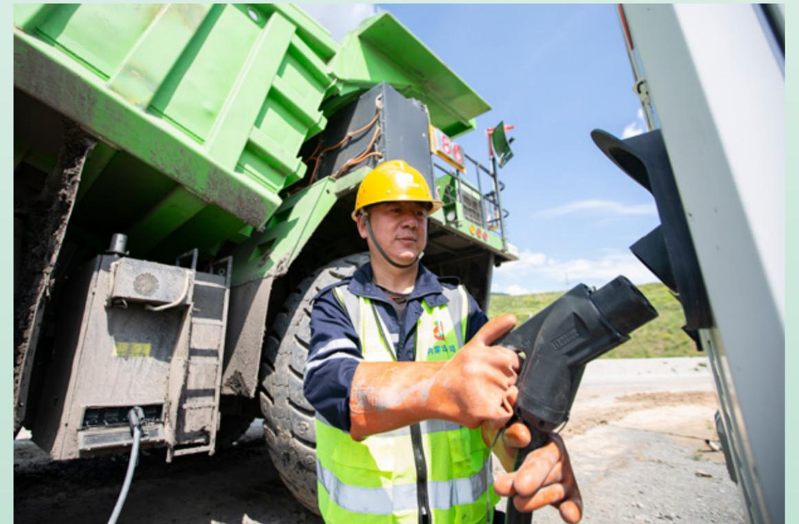
司机正在对世界首台百吨级纯电交流传动自卸车进行充电作业
