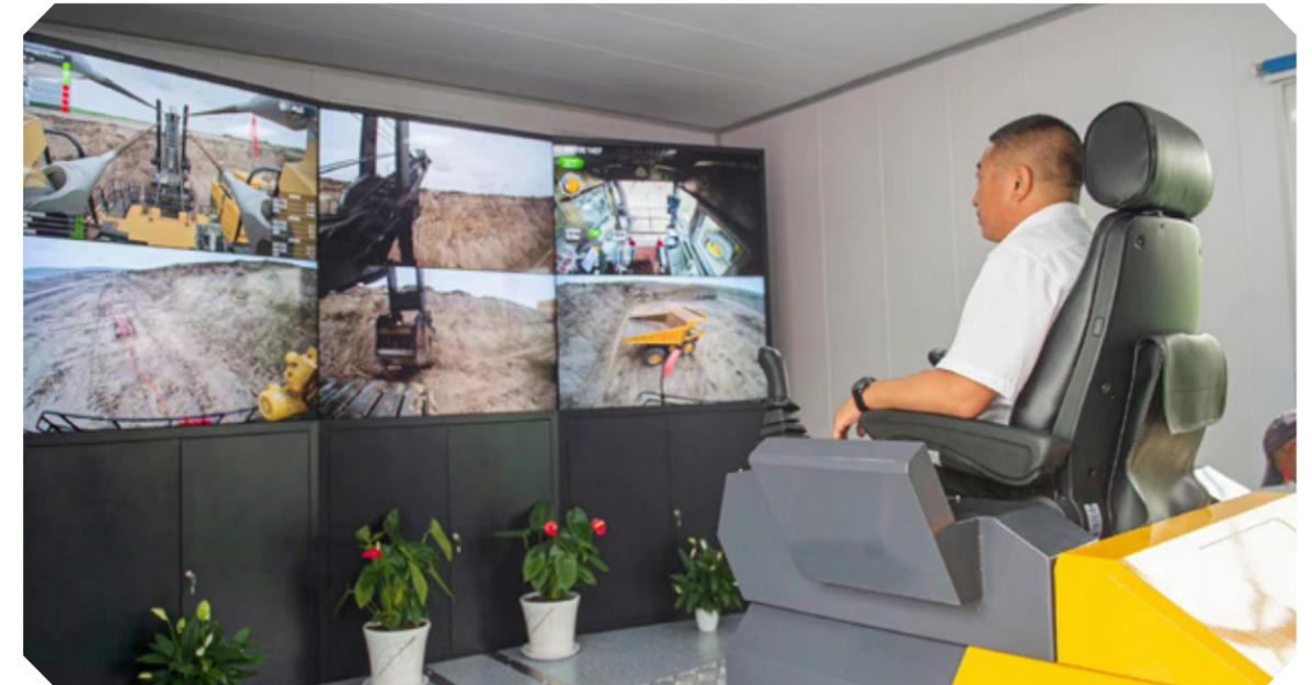
南露天煤矿挖掘机远程控制项目以5G组网为基础，应用世界先进的NAT穿透技术进行公网内的点对点连接，在世界上任何一个有5G网络的地方都可实现对挖掘机的远程控制。
