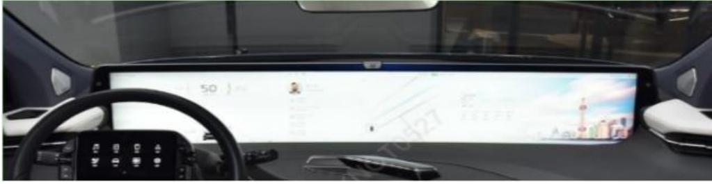
公司汽车电子客户包括日系、欧系、美系、德系品牌车商，覆盖了全球 70%以上的车辆品牌。近年来，公司推出的以搭载 3D 曲面车载盖板的的车载屏模组业务有助于汽车终端座舱具有更好的一体化显示效果，通过热压成型，将平面玻璃加工成 V、C、S、L、U、W 等不同形态的曲面玻璃，并通过曲面印刷技术制造成完整的车载 3D 盖板，3D 盖板尺寸能达到 1.6 米×0.6 米，最小曲率半径  $R < 30$ 。公司以卓越的创新能力和深厚技术储备不断满足客户异形定制需求，提升用户体验，现已完成“车载 Sensor+ 车载触控模组+车载盖板+车载触显一体化模组”的产业链布局。定位于高端显示制造领域，其厂房、产线、设备等空间布局具有一贯性，并按照行业最新先进水平搭建，配备了自动化水平更高、精度更优、尺寸跨度更大的设备，具有自动化程度高和低成本优势。以上技术优势、产业链布局优势、产线优势得到客户认可，促进公司车载触显模组全贴合产品出货量放量增长，现已在国际、国内车载客户供应链体系中占据重要地位。
