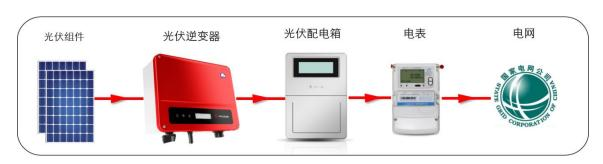
公司的光伏并网逆变器均为组串式逆变器。相较于集中式逆变器,组串式逆变器具有最大功率跟踪电压范围宽、转化效率高、组件配置灵活、性能安全可靠等特点,可满足户内、户外等不
