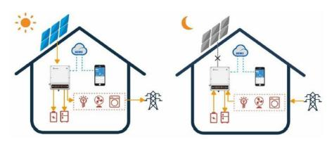
光伏储能逆变器的技术路线根据是否与电网连通主要分为并网型光伏储能和离网型光伏储能, 其中以并网型光伏储能为主。离网型光伏储能系统主要应用于海岛、无电网覆盖的偏远地区等场 景。随着部分国家对光伏并网发电补贴越来越低、部分区域甚至取消补贴,以及并网售电价格的下降,储能将成为提升并网光伏系统收益的重要手段。同时,光伏发电作为一种间歇性能源,发电功率的波动给电网系统带来一定冲击,储能系统可抑制或减少上述冲击,光伏并网储能逆变器将成为行业的重要发展方向之一。
