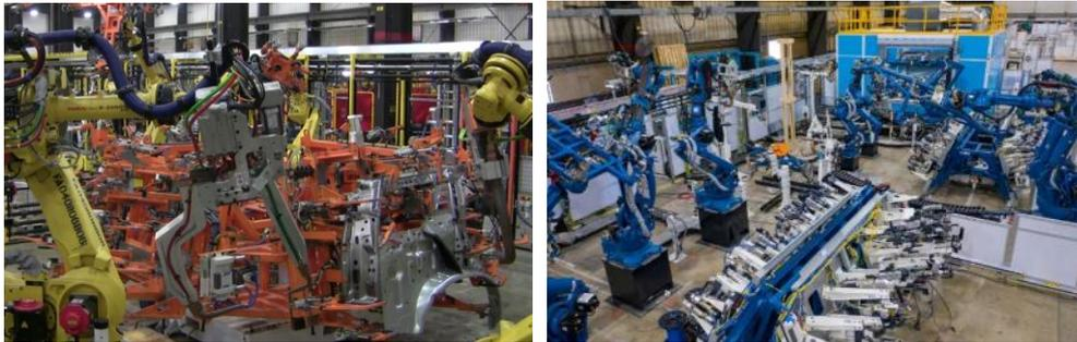
图 2. 车身焊装自动化生产线
