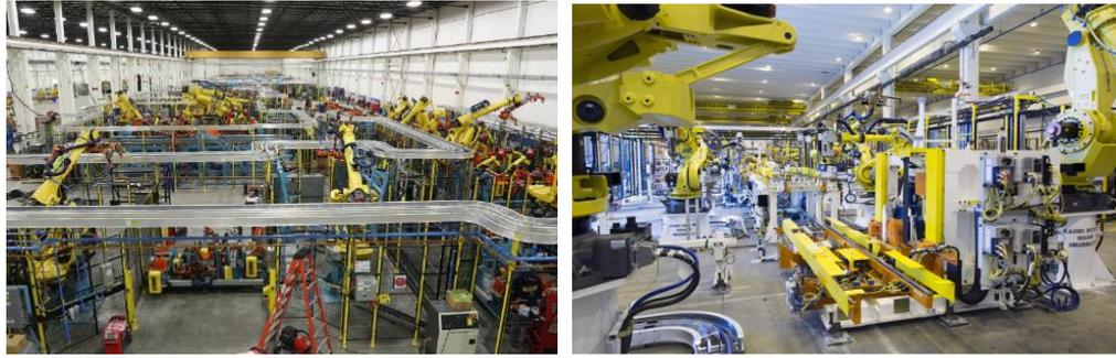
图 3. 结构件焊装自动化生产线
