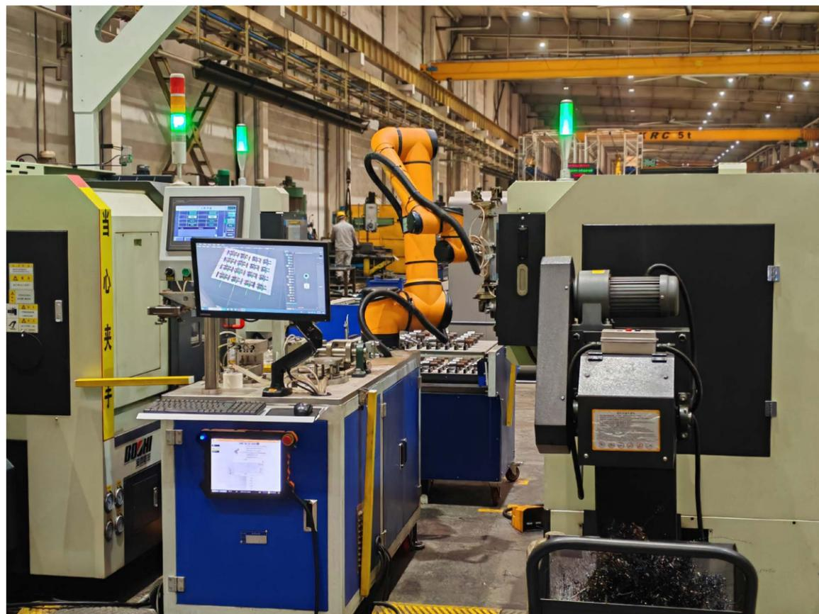
国机汽车所属中汽工程自动化车削单元
