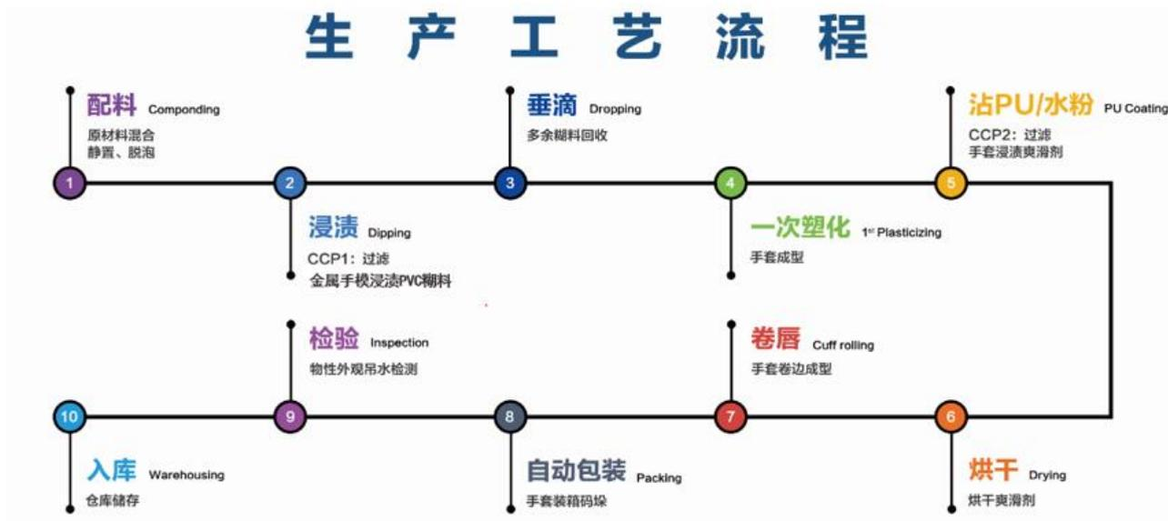
一次性PVC手套生产的主要工艺流程为：金属手模浸渍PVC糊料经垂滴后进行塑化，降温冷却后浸渍PU或水性玉米淀粉，干燥后进行卷唇，经预脱、自动脱模机后，分拣出缺陷品后进行码查包装。之后用毛巾等擦拭手模余料，干净的手模再次浸渍PVC糊料进行循环生产。
