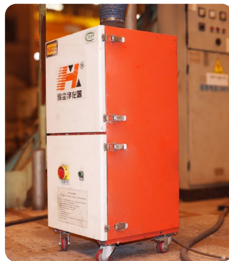
移动式焊接烟尘回收装置
