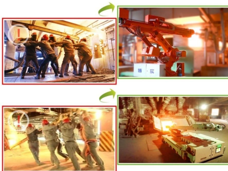
图示：公司针对电石矿热炉领域出炉机器人、捣炉机器人替代人工作业示意图
