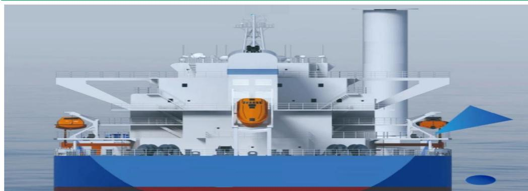
装有我司结构设计制造转筒帆散货船——“长航盛海”轮完成了实船试验验证，并获取船级社认证证书。视船舶类型不同，使用过程中可以降低大约5-25%的燃料油消耗，相应降低CO2排放，节能效果十分显著。
