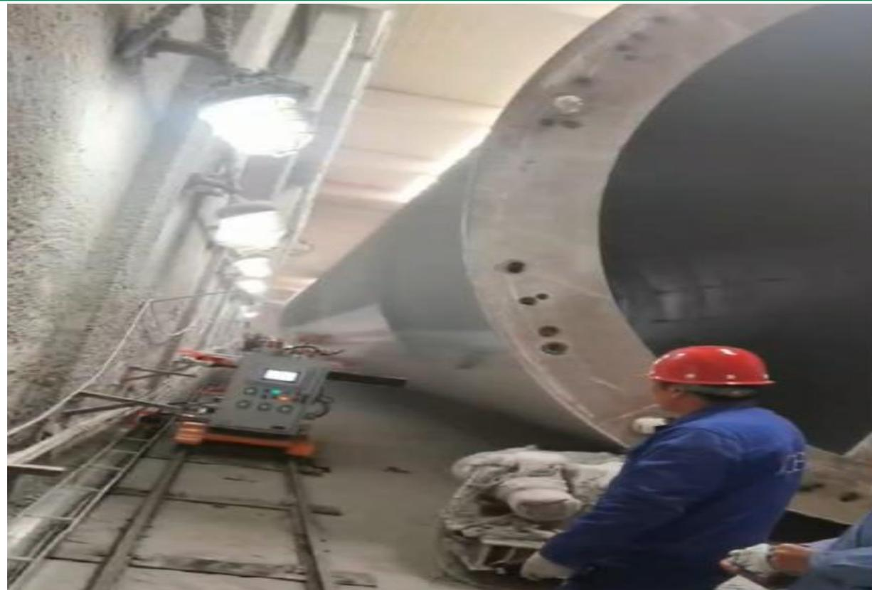
公司生产工厂喷涂工艺采用自动化作业，解决了原人工喷涂过程中，容易产生的职业病危害及人工疲劳导致的质量不可控因素，喷涂效率提升约30%，油漆消耗节省约20%，解放油漆喷涂业者，远离喷涂职业危害。
