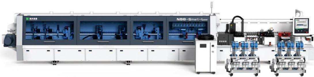
智能封边机主要用于智能柔性封边连线上，通常采用左右封边连线或四机封边连线，最高速度可达 40m/min，每分钟可完成 15-18 片工件封边。通过自动扫码实现选胶，选封边带，选刀等功能，工件一次通过即可完成多边封边。设备配置 PC 控制、钢制压梁、履带压料、两组快速上溶胶供胶、24 通道伺服精准送带（2 组 12 通道）、伺服齐头、伺服精修、伺服仿形等配置。
