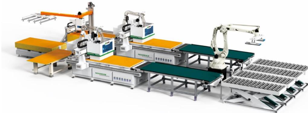
智能电脑裁板锯 NPC330-Smart 专为大规模定制裁切打造，是对电脑裁板锯的一次技术革新，集成机器人替代人工抓板、转板、缓存等操作，实现全自动、高柔性、高效率锯切开料，效率可达 2.5-3 片/分钟。出料端配置全自动贴标，实现一板一码，便于后续数字化生产。采用机器人捡板、转板，极大地减轻了工人的劳动强度，有效地降低了用工成本。多组智能电脑裁板锯并联，前段能与平面仓无缝对接，后段能与智能封边对接，实现工业 4.0。
