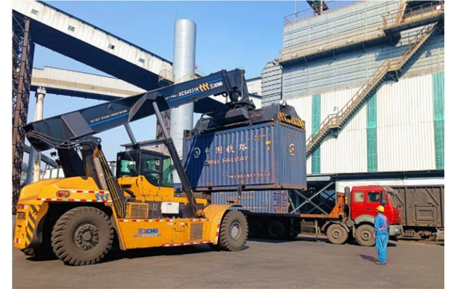
正面吊卸车设备进行卸车作业
