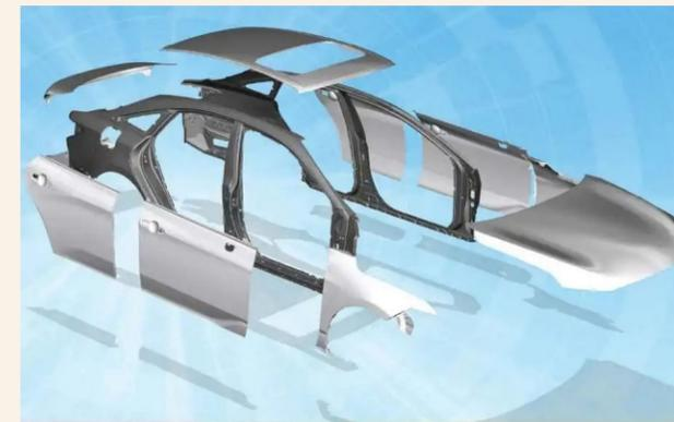
超高强度热成型钢助力汽车轻量化
