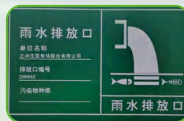
雨水排放口标识牌
