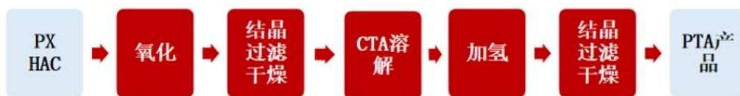
嘉兴石化、嘉通能源 PTA 生产工艺，以 PX 为原料，HAc 醋酸为溶剂，以醋酸钴、醋酸锰为催化剂，氢溴酸为促进剂，在氧化单元反应器中与通入适量的空气进行中温液相氧化反应。生成的对苯二甲酸经结晶、真空过滤和干燥得到产品粗对苯二甲酸（CTA）。粗对苯二甲酸精制单元高温下完全溶解于脱离子水中，进行加氢精制反应，将粗对苯二甲酸的主要杂质 4-CBA 转化为 PT-酸，通过五级结晶、一级过滤分离和干燥，得到适于聚酯生产的高纯度的 PTA 产品。
