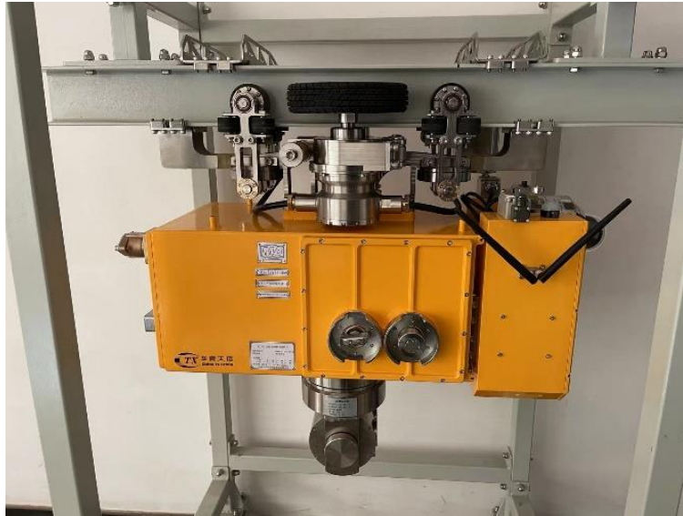
图 36、防爆式轨道智能巡检机器人
