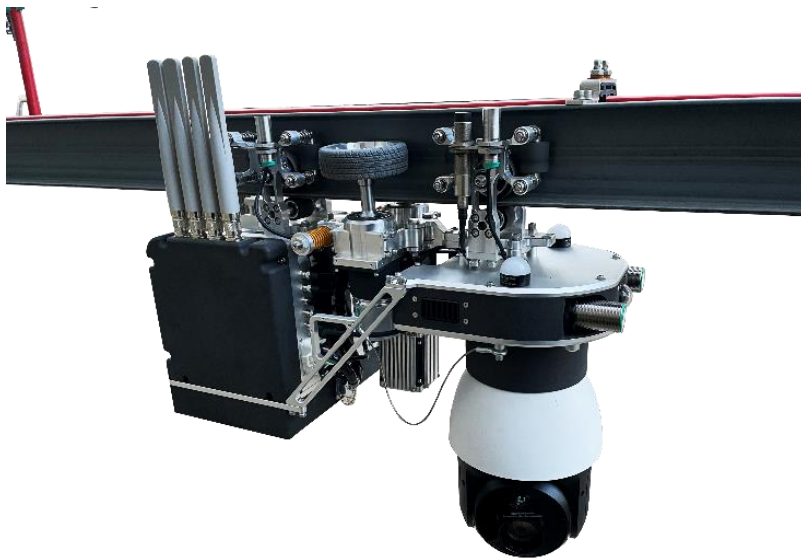
图 39、隧道巡检机器人
