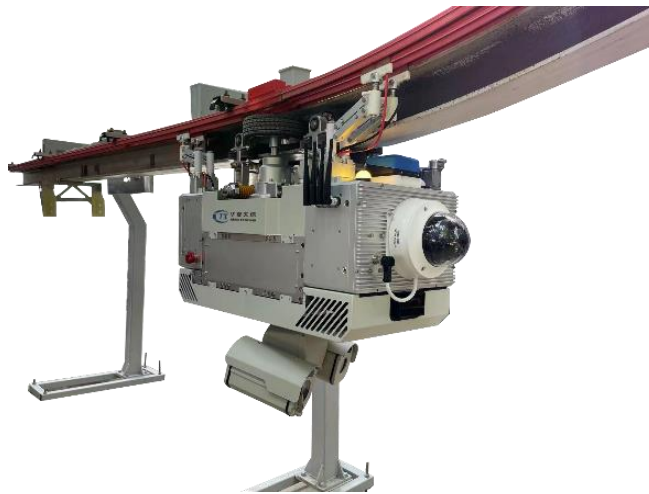
图 37、极寒轨道式智能巡检机器人
