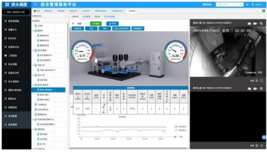
供水运维系统主要用于为供水企业的日常运营管理提供支持,主要包括工单系统和巡线管理系统两部分:工单系统可以通过报警信息或自主创建工单并分派任务给员工并进行全程跟踪;巡线管理系统为管道巡查工作提供实时监控,从而更有效的对管道巡查工作进行管理。软件控制界面如下:
