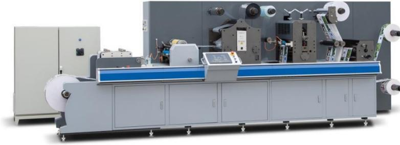
间歇·全轮转商标模切机（ZM-320）采用圆压圆模切方式，速度最高可达 120 米/分钟。该机配备有先进的伺服控制系统，可按需要选配各种功能装置，完成放卷、纠偏、柔印上光、冷烫、覆膜、分条复卷等印刷及印后工序。
