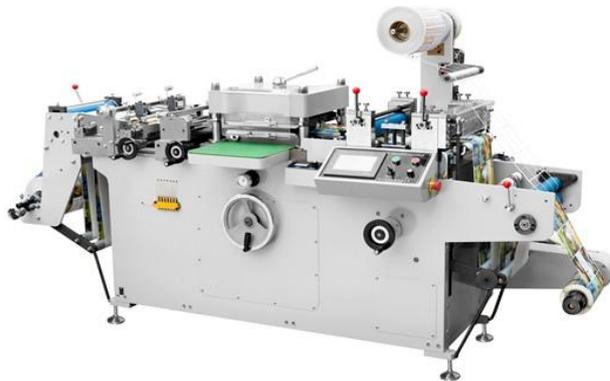
自动不干胶商标模切机（WQM-320G/420）能够进行平压平高精度模切，拖料及切片由电脑控制，印刷标两边及纵向由三只光电眼精确跟踪定位，能够实现精准模切，模切、收废、切片等工序全部自动化完成，可与公司的柔印机系列、胶印机系列等设备配套使用。
