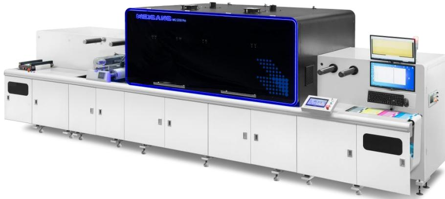
数码印刷机（WG S350 Pro）在外型上就明显区别于传统标签印刷机，它采用了简约、科技感的设计风格，给人一种年轻化、智能化、数字化的既视感。这款设备拥有灵活高效的印刷配置，在色彩组合方面非常灵活，可任意组合色彩以及增效方案；它可以兼顾高效率以及作业方案的灵活性，设备搭载了经久耐用的高精度压电喷头，可实现印刷品质始终如一的良好效果，而且支持全天候生产。印刷速度可达 60 米/分钟，印刷宽度可达 350 毫米，大大拓宽了用户的应用范围。设备采用的是 single-pass 喷墨方案，属于非接触式打印方式，一次成型、无需制版；印刷精度最高可达 1200\*600dpi，另外还有 900\*600、600\*600 精度模式可选，不仅成像细腻，而且色彩非常饱满；此外，WG S350 Pro 采用英国 Hybrid Software 的 GGS 图形软件，全球首个基于 AI 智能的专利软件，色彩管理更加智能、方便、快捷。该机型引入柔性印刷技术，结合柔版印刷的优点，采用 CMYK+专色的应用系统，色彩还原度高，白墨光油还可实现各种数字增效应用，使得产品呈现更精致细腻的打印效果。
