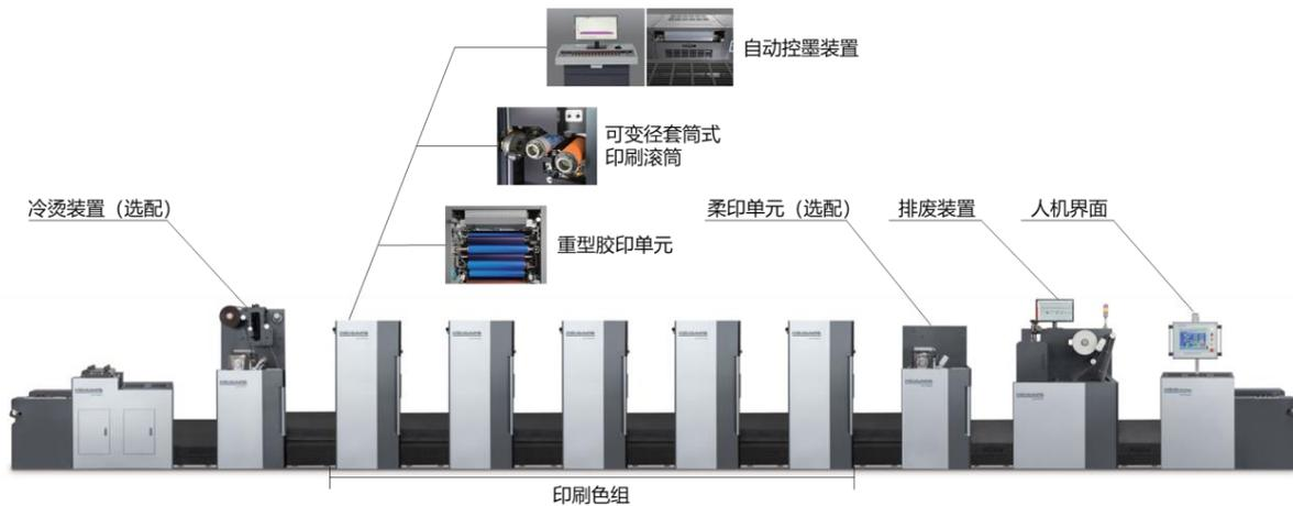
组合式高速全轮转（套筒）胶印机是公司在间歇式 PS 版商标印刷机（胶印）的技术储备基础之上，结合标签印刷市场发展趋势研制而成的最新产品。该产品创新性地研发出了可变径套筒式印刷滚筒，印刷图案长度与印版滚筒表面周长接近相等，可实现全轮转连续式印刷，解决了传统胶印机滚筒只能进行间歇式印刷的痛点，大幅提高了印刷速度，将最高印刷速度提高至 180 米/分钟。版滚筒和转印滚筒采用气胀套筒式，两个滚筒可根据印刷图案长度同时更换，适应不同长度尺寸图案的印刷，换版速度快，简单易操作，印刷效率高。该机型的传墨机构可以自动调整来适应版滚筒外径的变化，优化设计传墨路线，匀墨效果好，印刷压力平稳。配备的自动控墨装置可以实现一键式调节，墨量自动控制，精准供墨，提高了印刷精准度并减少了浪费。
