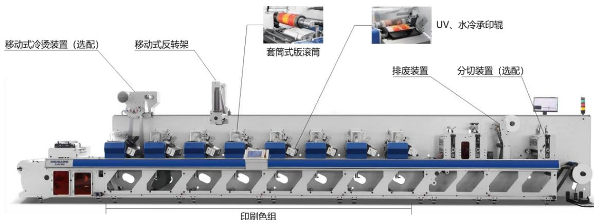
机组式柔性版印刷机（ZJR-350/450/650）最高印刷速度为 180 米/分钟，与间歇式 PS 版商标印刷机（胶印）相比，由于其速度更快、制版成本较高，更适用于大批量的印刷。整机控制系统采用微机伺服
