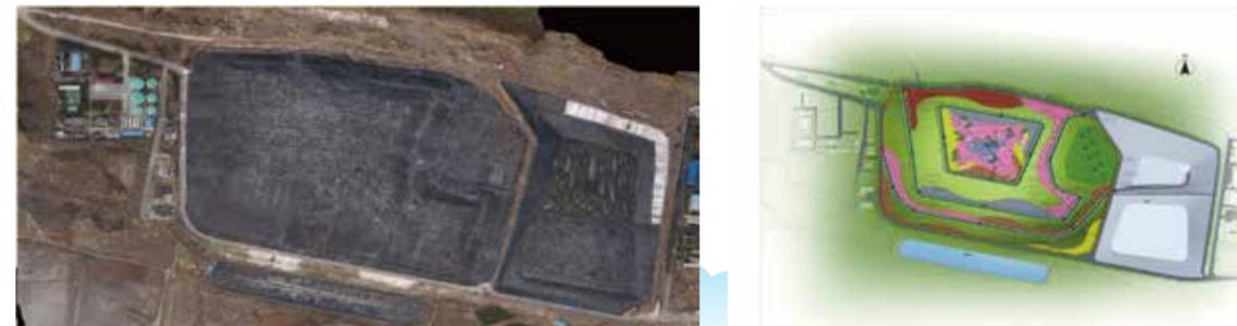
本封场治理工程封场面积约为 97000 平方米，项目建设性质为改造工程；主要包括对填埋场内积存的渗滤液进行处理；对现状 A、B 库区的垃圾堆体进行原位封场修复；对生活垃圾填埋场 C 库区进行垃圾转运及雨污分流工程等。库区防渗系统、地下水导排系统区渗滤液导排系统保持现状。
