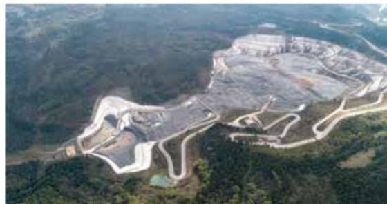
成都长安生活垃圾填埋场占地 1500 余亩，是全国十座大型生活垃圾卫生填埋场之一。2018 年填埋场扩能项目建设完成，新增库容 582 万立方米、飞灰填埋区 10.6 万立方米。中兰环保提供填埋场日常运营维护服务。
