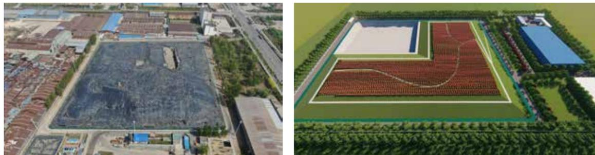
项目包括垃圾筛分与分选工程（存量垃圾开挖、垃圾分选约 28 万吨、筛分重质物回填约 14 万吨及筛分轻质物外运处置约 14 万吨；飞灰填埋区建设工程（将第二填埋区改造为飞灰填埋区，设计有效库容约 10 万立方米。其中包括钢筋混凝土垃圾分隔坝、库区防渗系统和淋浴水导排等系统建设）；以及封场工程（第一、三、四填埋区进行覆盖封场，三个填埋区封场覆盖总面积约 4 万平方米，封场容积约 40 万立方米）。
