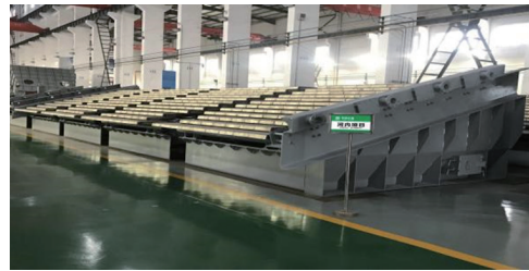
850 吨 / 天大吨位模块化生活垃圾焚烧机械炉排炉
