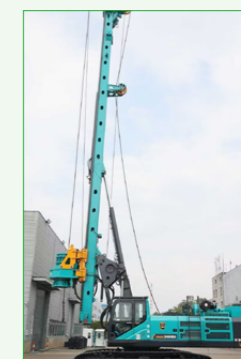
SWDM240HES 液压混合动力旋挖钻机
