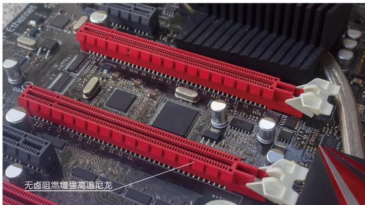
图 8 公司高温尼龙材料在电脑、服务器关键连接器上的应用场景图
