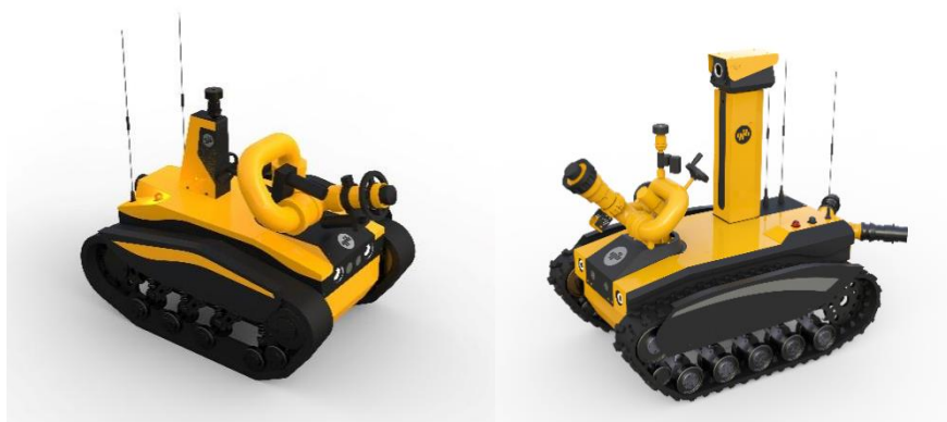
消防灭火机器人
