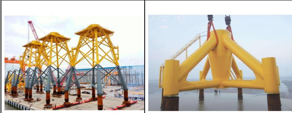
公司生产的导管架是海上风电设备的组合式支撑基础，由上部钢制桁架与下部多桩组配而成，上端与风电塔筒相连、下端嵌入海床地基中，起到连接和支撑作用，适用于复杂地质地貌的海洋环境。
