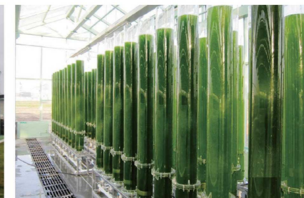
示范项目内柱式反应器培养系统示例
