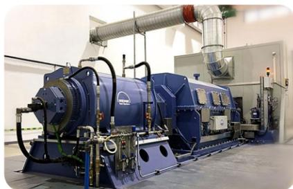
高速动车1:1制动动力试验台
