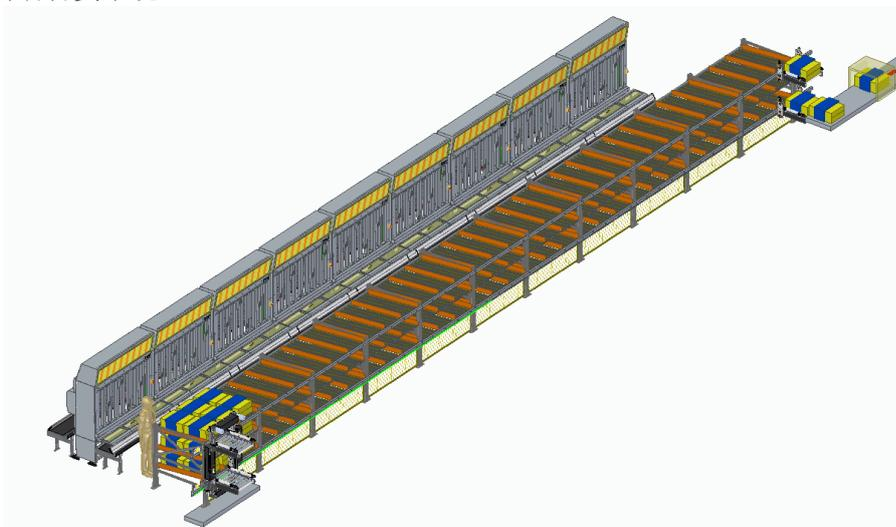
柜式机自动备货系统，该系统可实现柜式机件烟自动备货，满足标、细、中、短不同类型件烟的备货需求。替代原人工补货缓存方式，提高补货效率和准确率，降低工人劳动强度和人工成本。
