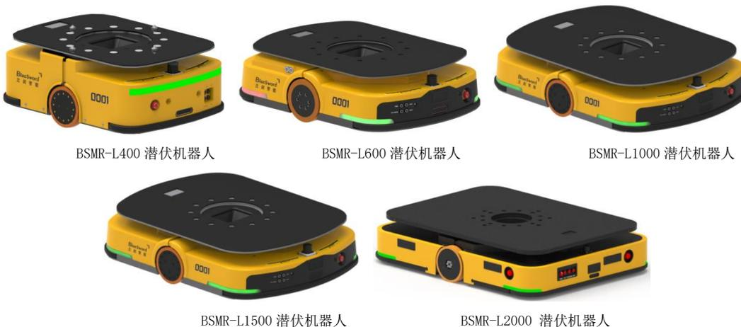
公司完成二代潜伏机器人全系列产品的开发定型（400kg/600kg/1000kg/1500kg/2000kg），性能全面升级，全新的自研控制器、控制架构，其中大量采用高压压铸、注塑等成型工艺，大大提高了产品的批量加工、快速交付能力，同时其多样化的功能选配，适配多样化的市场需求。
