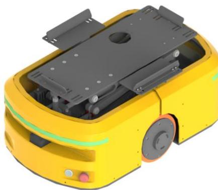
T40 料箱搬运机器人为公司自主研发设计的料箱搬运机器人 AGV。适用于料箱立库接驳、线边配送、货到人拣选等多种场景。相较于传统输送线方案，T40 具有柔性高、部署快、效率高、组合形式多样等优势。T40 料箱搬运机器人采用先进的导航技术，结合精准高效的车体控制算法实现精准导航；可大幅提升仓储系统运行效率。结合公司自研的数字孪生仿真平台，能够在多种复杂应用场景下快速部署上线。
