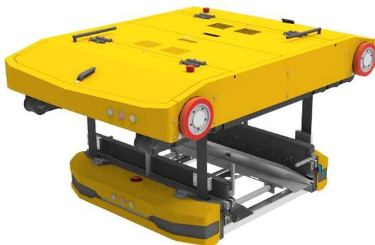
公司自主研发的蜘蛛料箱机器人，具备高柔性、已部署、易维护的特点。可以选择单巷道单机器人，也可以选择单巷道多机器人，同时可以与提升机等常规设备进行组合使用，进一步提高系统运行效率。可适用于各类作业场景，相比于其他料箱出入库机器人，蜘蛛料箱机器人存储量更大，对货架及地面的要求更低。
