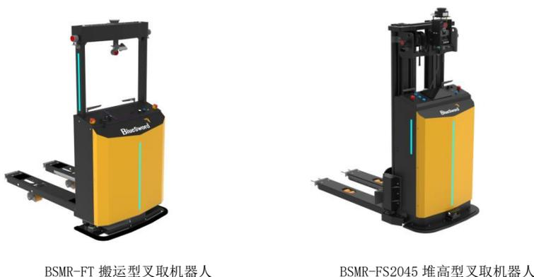
公司进行了 FT 搬运型、FS 堆高型、FC 平衡重型、FR 前移型四大系列叉取机器人的研发，采用模块化、系列化的设计理念，额定载荷覆盖 1000kg、2000kg、3000kg，举升高度覆盖 1.6m、2m、3m、4.5m，采用弹簧液压等驱动悬挂技术，有效的提高机器人空、负载工况下的地面适应能力，更具备视觉避障、托盘视觉识别、托盘异常检测等诸多选配安全功能，多样化的产品系列划分，可全面适配各工况下，托盘级物料的自动化搬运、堆垛的市场需求。
