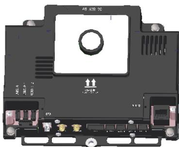
完成高集成度潜伏机器人控制器开发机量产，集成：8 核异构 ARM 处理器、双视觉模组、交换机等核心功能，大幅降低整机成本及复杂度，提高产品核心竞争力。
