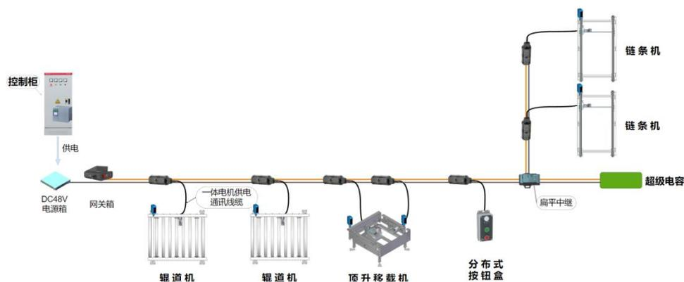
相较于经典的交流输送系统,分布式超低压直流伺服输送系统具有运行更节能、用电更安全、输送更平稳、定位更精准、安装更快速、检修更便捷的显著优势。
