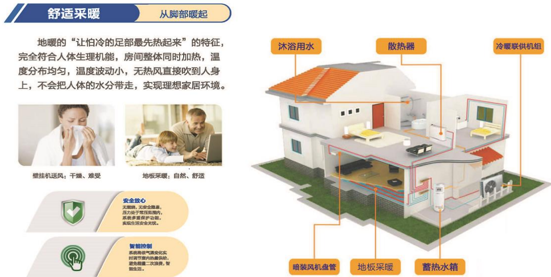
图 3：空气源热泵机组供暖方案
