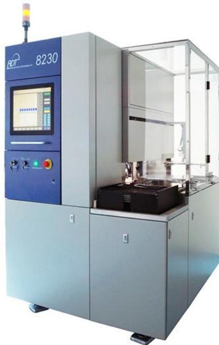
8230 是一款高精度、高性能的双轴 12 英寸全自动切割机（可兼容 8 英寸），除了可以切割硅晶圆、封装基板等各种材质、各种尺寸的电子组件外，还适用于 SiC、陶瓷、蓝宝石等硬脆材料的切割。8230 性能指标处于国际一流水平，获得客户的高度认可，批量应用于头部封测厂，并在高端先进封装制程中得到批量应用。
