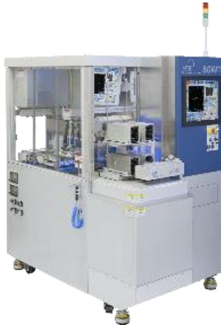
Wettable QFN 是针对汽车电子等对可靠性要求高的应用领域中对 QFN 封装芯片的焊接可靠性和可检视性的要求发展出的新型封装结构，可以提供更高的焊接良率和更方便的可视化检测。80WT 和 82WT 适用于 wettable QFN 等对切割深度控制要求高的产品，可以在表面不平整的大型封装基板的阶梯实现定深切割，切割中无需贴膜，节省耗材。80WT 和 82WT 作为一款成熟且稳定的设备，凭借卓越的性能和先进的技术，以及定制化开发的刀片，已成为 wettable QFN 制造的领先解决方案。80WT 和 82WT 已获得全球头部封测企业订单，产品性能得到客户的高度认可。
