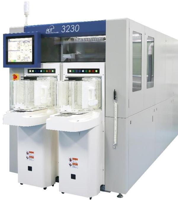
3230 是一款高精度、高稳定、高效率的全自动减薄机。适用于 6、8、12 英寸晶圆的减薄加工，也可用于碳化硅等超硬材料的加工。3230 使用公司自主研发的高刚度高功率气浮主轴和气浮转台，在保证加工精度的前提下，具有灵活的工艺适配能力和高的加工效率。设备于 2023 年 6 月推出后，获得了行业内广泛关注，已应用于硅、碳化硅晶圆的减薄工艺。
