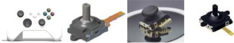
精准定位控制器（Joy-stick），摇杆系列产品。公司精准定位控制器关键技术显著改善了产品漂移问题，并已在国内及日本取得专利授权，产品小巧轻便，复位精度高，具有 2,000 万次以上使用寿命，可被应用于 VR/AR、无人机、远程医疗等需要精准定位及实时遥控的领域，技术门槛高。
