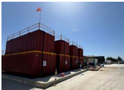
甘肃某油田压裂返排液废水处理项目——集装箱可移动式成套设备产品
