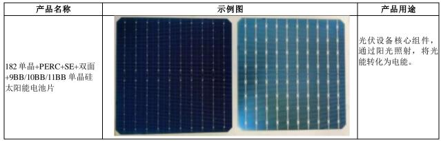
金寨嘉悦新能源一期项目产品的技术路线采用 PERC+SE 技术, 叠加的 SE 技术通过在金属栅线与硅片接触部位及其附近进行高浓度掺杂, 而在电极以外的区域进行低浓度掺杂, 既降低了硅片和电极之间的接触电阻, 又降低了表面的复合, 提高了少子寿命, 使电池具有以下 3 点明显的优点:
