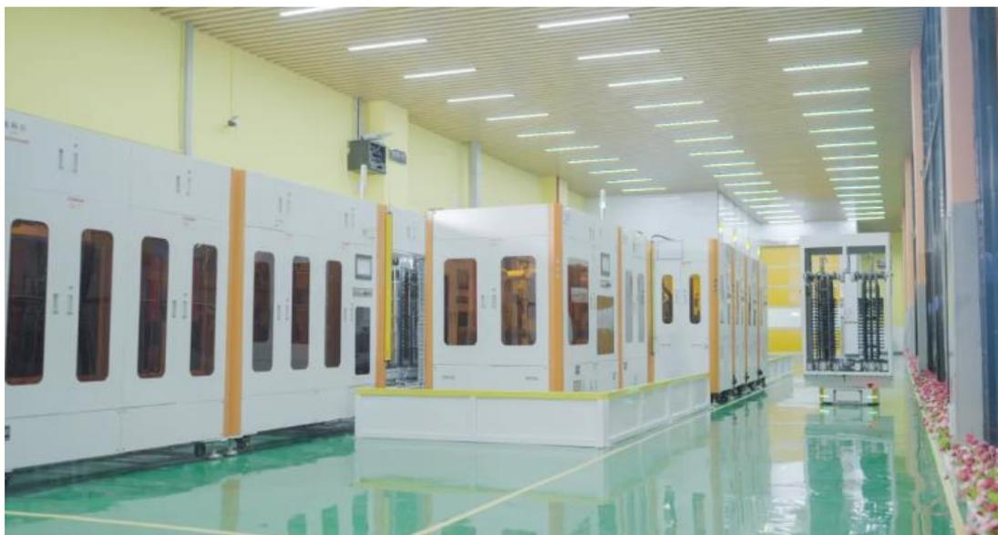
公司的CNC车间配备了大量AGV与机器人，有序管理生产节奏。AGV自动实现CNC的装夹工作，通过数据信号指引，将已经加工完成的产品从机器中取出。AGV也会进行新刀具更换和旧刀具回收。夹具装卸和刀具更换都在生产管理系统下精准进行，大大提高设备稼动率。此外，CNC智能车间还配备了一键测量实验室。以前，每台检测机都会配备一名操作员进行零件测量。现在，一键测量技术可以通过AGV来替代操作员进行自动装夹，提高检测设备的利用率。最重要的是，检测完成后，数据可以自动传输到生产管理系统，并对数据进行自动分析与加工参数的自动补偿，大大缩短了机台的调试时间并节省了技术资源。
