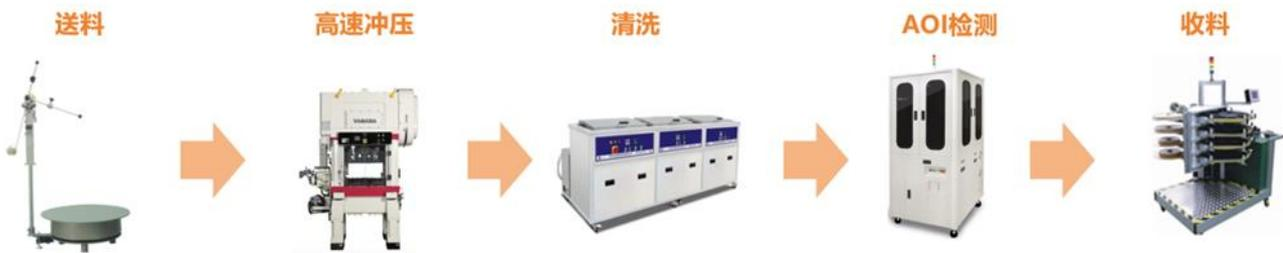
冲压速度一直是冲压工艺挑战的技术难题，高速精密冲压技术是兼具冲压速度与高精度、效率极快的冲压生产工艺，高速精密冲压是设备、模具加工、模具设计、智能控制等技术的结合体，可有效减少模具开发量，适合精密件的大规模生产，最能充分体现一家现代化制造企业的技术层次和软硬件实力。公司的高速冲压技术，其速度较普通冲床提高了10倍以上，其稳定性依赖于专业的模具设计、模具加工以及整套保养系统。为了匹配高速冲压，公司还开发出高速包装机。其整合了尺寸和外观的自动化光学检测，同步导入了不停机换料技术。高速冲压与高速包装可以将生产效率提升10%以上。公司已在3C电子、连接器、汽车电子元器件等方面全面应用高速精密冲压技术，具有一人多机降低成本、提高效率、保证了产品高品质尺寸稳定。
