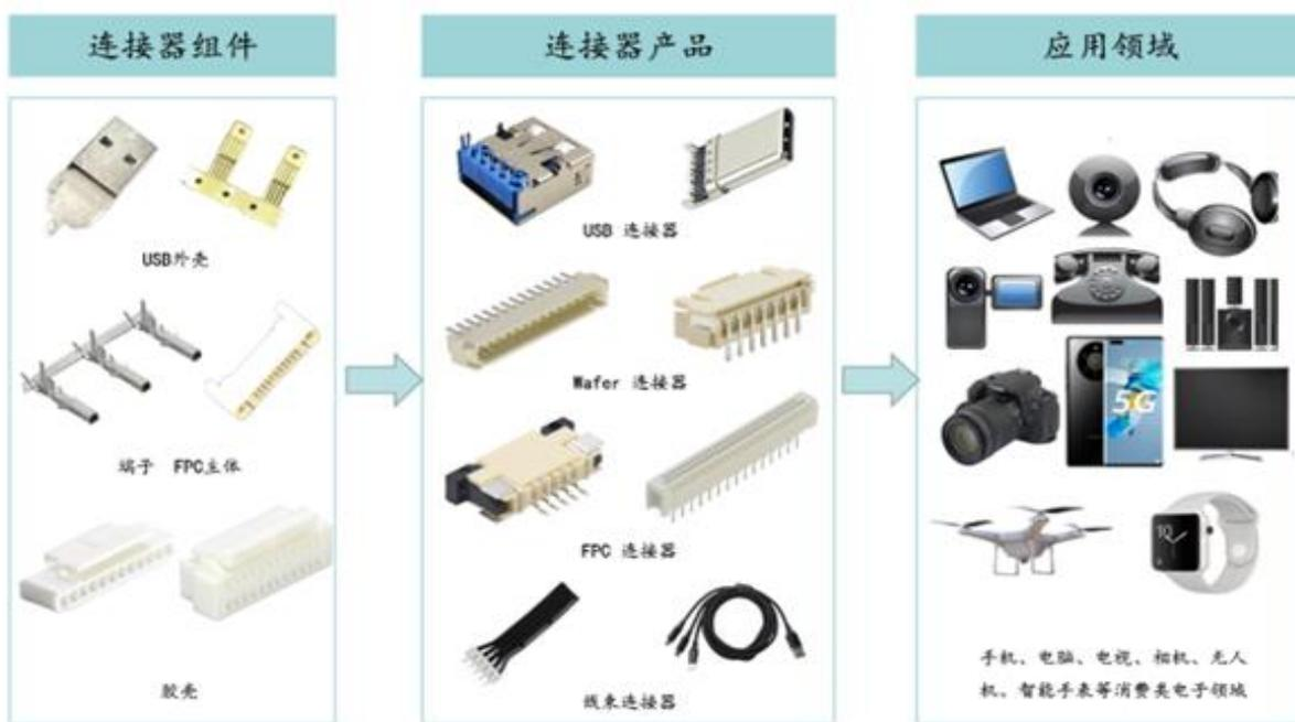
端子和胶壳属于连接器的零组件。其中，端子用于传递信号或实现导电功能；胶壳用于保护和固定端子，并起到绝缘作用。
