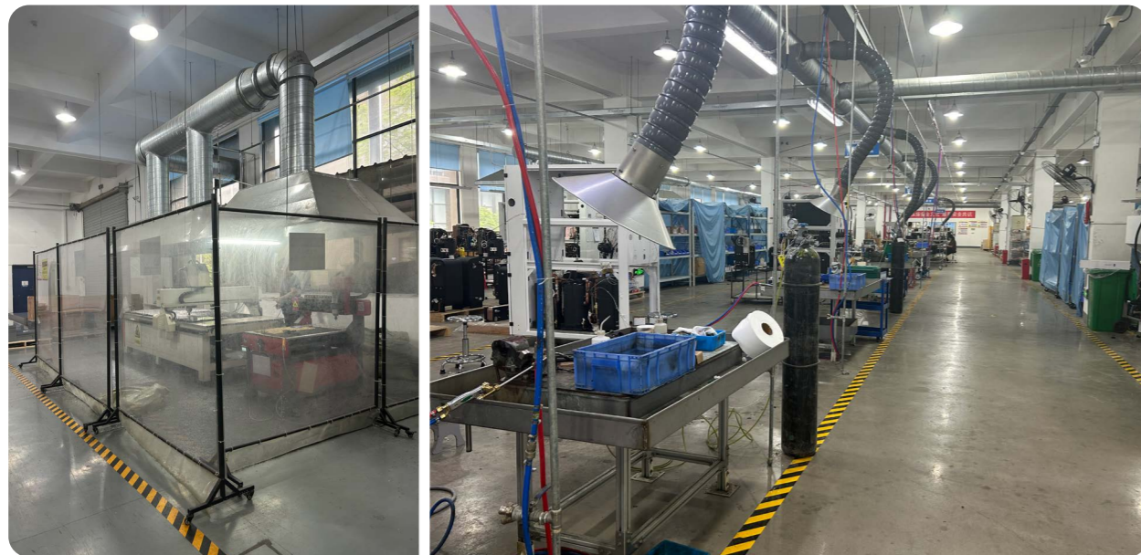
安徽京仪对工厂氩弧焊接模块、钎焊焊接模块、包棉涂胶模块、PVC板材下料模块进行改造，增加有机物、焊烟净化装置
