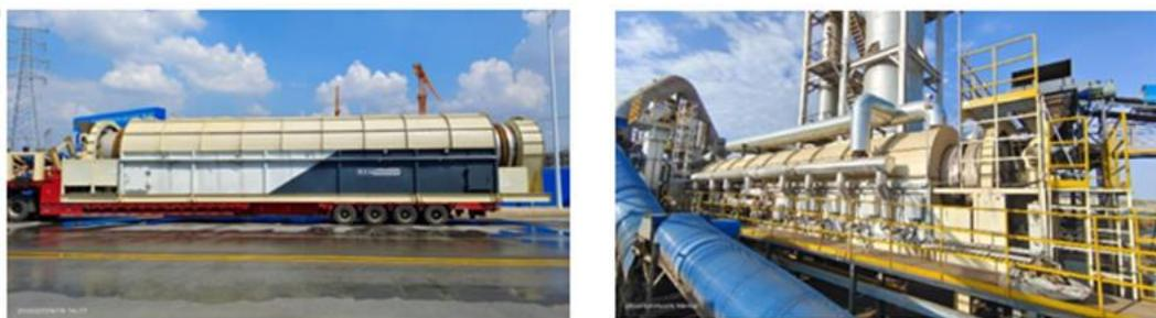
针对化工、矿山采选冶等场地污染土壤，公司结合国家重点研发计划“铍矿区铍砷污染源阻断及生态治理技术”，持续开展土壤增效生物淋洗、淋洗剂回收、废液净化等技术、装备工艺研究。开发的绿色高效生物淋洗剂，重金属污染土壤一级淋洗效率可达 90% 以上；通过研发的固-液-固转化工艺，可从淋洗废液中回收 50% 以上生物淋洗剂，在保障淋洗效率的同时，进一步降低药剂用量及技术成本，最大程度维持土壤微生物代谢及有机、无机碳库，保障土壤碳汇能力；废液净化后满足《城镇污水处理厂污染物排放标准》（GB 18918-2002）一级 B 标准，最终实现污染土方量、污染物及污染排放的减量化。
