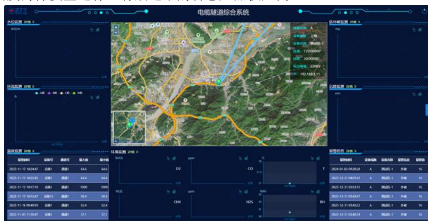
图：电缆隧道监测系统
